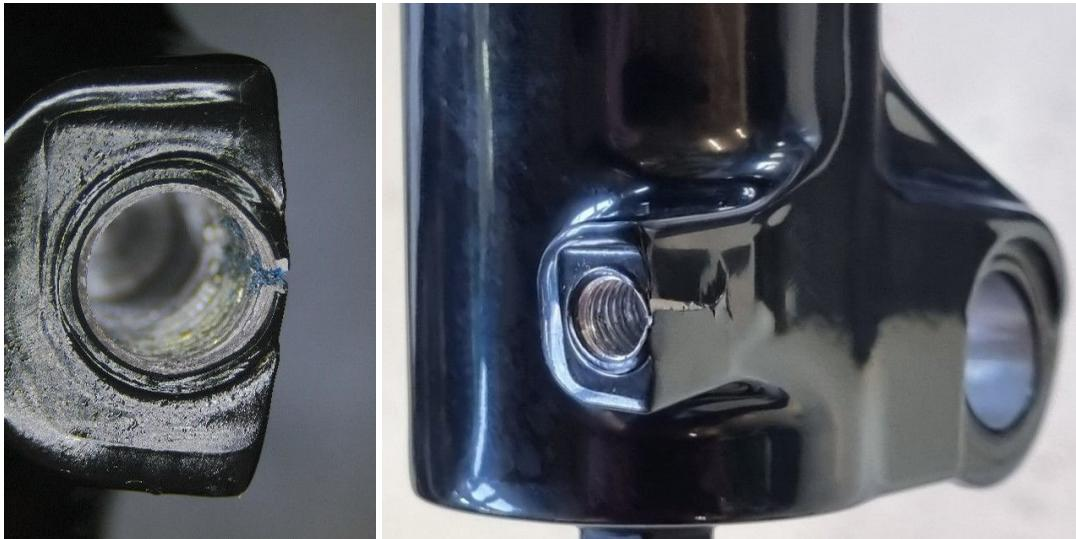
Bitte überprüfe alle Federgabeln des Typs FOX AWL HD in deinem Lagerbestand, indem du die Wandstärke zwischen dem Gewinde und der Innenseite der unteren Sattelaufnahme wie abgebildet mit einem Messschieber misst.
