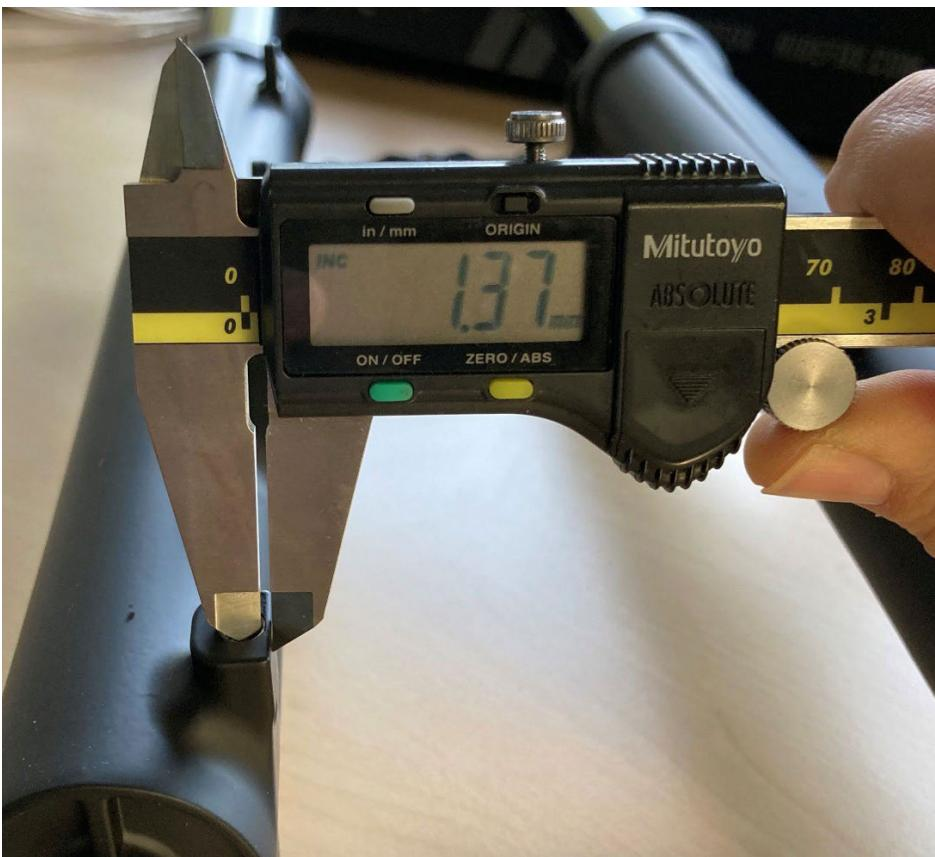
Die Messschieber müssen vor der Verwendung sauber und genullt sein. Die Wandstärke der unteren Post Mount-Aufnahme von der Innenseite der Gewindebohrung bis zur Innenseite der Post Mount-Aufnahme messen. Den Messschieber mit den Klemmbacken parallel zur Bohrung der Post Mount-Aufnahme halten (NICHT KIPPEN).
